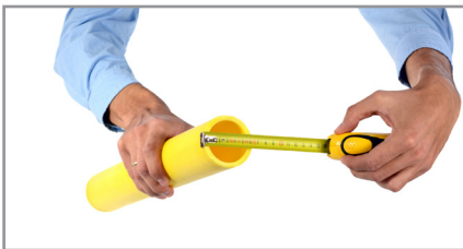
1. Medir o diâmetro do tubo.
