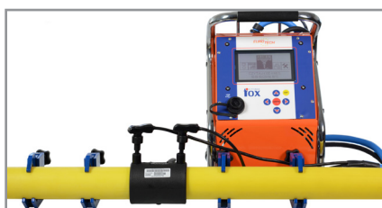
11. Início da soldadura.
