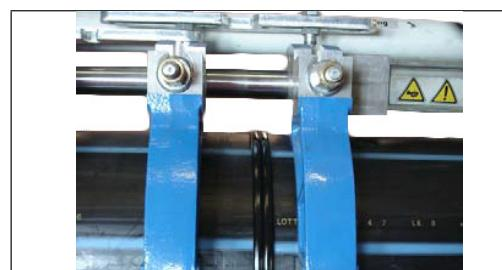
9. Aumentar progressivamente a pressão (rampa de pressão) desde zero até à pressão requerida  $p_1$ , num tempo  $t_4$  e mantê-la durante um tempo  $t_5$ . Deixar arrefecer a soldadura nesta posição sem retirar a pressão  $p_1$  nem aliviar as abraçadeiras. Decorrido o tempo de arrefecimento, aliviar as abraçadeiras e retirar o tubo da máquina.
