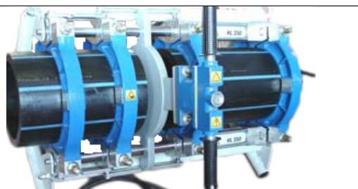
6. Limpar as faces da placa de soldar com isopropanol (álcool).
