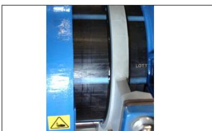
7. Colocar a placa entre os tubos a soldar e pressionar os seus extremos contra a placa, à pressão calculada  $p_1$ , até formar um rebordo inicial uniforme e de altura  $h$ . Reduzir a pressão até  $p_2=10\%p_1$ , para o aquecimento.
