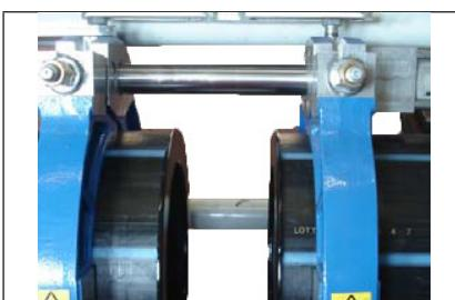
8. Decorrido o tempo de aquecimento  $t_2$  (tabelado em cada máquina), separar los tubos de la placa. Retirar la placa y unir rápidamente los extremos de los tubos en un tiempo máximo  $t_3$ .
