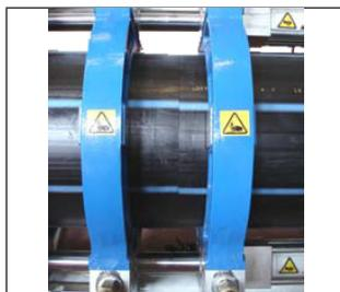
5. Verificar o alinhamento, controlando o paralelismo entre as extremidades dos tubos a soldar (tolerância máxima de 0,5 mm) e controlando o desalinhamento (tolerância máxima de 10% da espessura do tubo).
