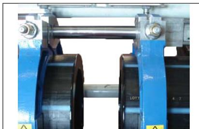
8. Decorrido o tempo de aquecimento  $t_2$  (tabelado em cada máquina), separar los tubos de la placa. Retirar la placa e unir rápidamente los extremos de los tubos en un tiempo máximo  $t_3$ .
