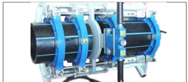
6. Limpar as faces da placa de soldar com isopropanol (álcool). Comprovar com um termómetro de contacto que a temperatura da placa esteja entre 210-225 °C. Comprovar a pressão de arrasto e registar a mesma na ficha de soldadura. Calcular  $p_r$ , a pressão para a formação do rebordo inicial (pressão de soldadura tabelada + pressão de arrasto) e registar a mesma na ficha.
