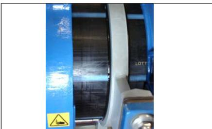
7. Colocar a placa entre os tubos a soldar e pressionar os seus extremos contra a placa, à pressão calculada  $p_r$ , até formar um rebordo inicial uniforme e de altura  $h$ . Reduzir a pressão até  $p_2=10\%p_r$ , para o aquecimento.
