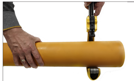
3. Cortar o tubo de forma totalmente reta. Cut the pipe straight.
