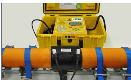
11. Início da soldadura. Start welding.
