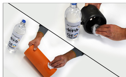
6. Limpar a zona de soldadura com líquido adequado. Clean the welding zone with special liquid.
