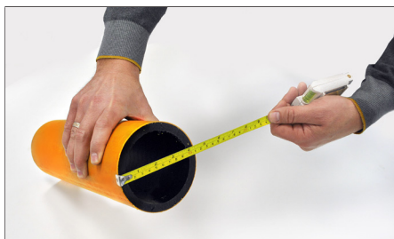
1. Medir o diâmetro do tubo. Measure diameter of the pipe.
