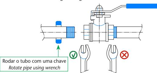
8. Como geralmente o comprimento da rosca do tubo é superior ao da rosca da válvula, é indispensável para evitar roturas na válvula, que o extremo do tubo nunca chegue a tocar o fundo da rosca da válvula. Deve garantir-se uma distância mínima de 1mm.
