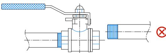
5. Nunca se deve apertar a válvula num torno de bancada, nem se devem usar extensões nas chaves. Pode provocar deformações ou roturas na válvula.
