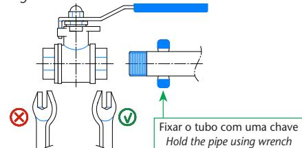
7. Segundo passo no aperto: A válvula mantém-se fixa e é o tubo que roda.
