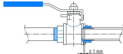
5. Nunca se deve apertar a válvula num torno de bancada, nem se devem usar extensões nas chaves. Pode provocar deformações ou roturas na válvula. Aquando da união do tubo com a válvula, a chave fixa ou inglesa deve ser colocada no hexágono do lado que se pretende unir. Não usar outro tipo de chave. Em geral, não ultrapassar um binário de aperto de 30 Nm.
