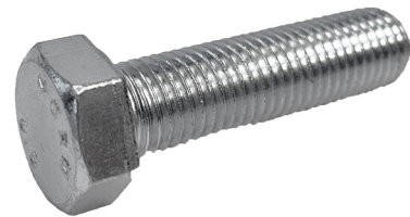
Bullone a testa esagonale in acciaio al carbonio zincato interamente filettato EN ISO 4017 (DIN 933) - Classe 8.8 - Carbon steel hexagonal head bolt with total thread and zinc coated EN ISO 4017 (DIN 933) - Class 8.8
