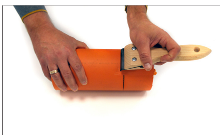
5. Raschiare l'area di saldatura del tubo. Scrap the welding zone of the pipe.
