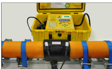
11. Inizio della saldatura. Start welding.
