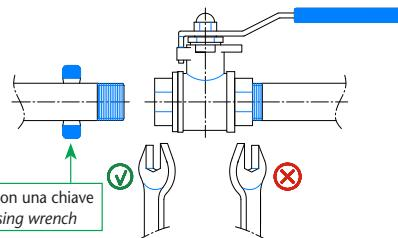
4. Verificare l'allineamento dei tubi. La valvola non compensa disallineamenti. Distorsioni derivanti da un allineamento errato possono causare problemi di tenuta, difficoltà durante le manovre o perfino rottura.
