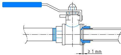
5. Non stringere mai una valvola in una morsa né utilizzare prolunghe chiave. Potrebbero causare la rottura o la deformazione della valvola.
