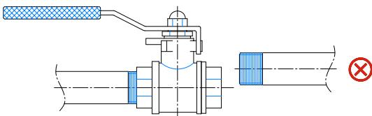
8. Poiché normalmente la lunghezza della filettatura del tubo è maggiore di quella della valvola, per evitare la rottura della valvola, è fondamentale che l'estremità del tubo non tocchi mai il fondo della filettatura della valvola. Minimo 1 mm.
