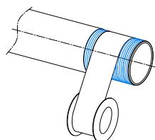
7. Secondo passo: la valvola viene mantenuta fissa e viene fatto girare il tubo.
