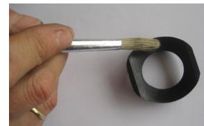
lubrifier le joint sur les surfaces de contact.
