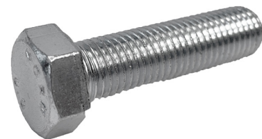
Vis à tête hexagonale en acier au carbone zingué avec filetage complet EN ISO 4017 (DIN 933) - Classe 8.8 - Carbon steel hexagonal head bolt with total thread and zinc coated EN ISO 4017 (DIN 933) - Class 8.8
