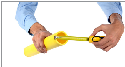
1. Mesurer le diamètre du tube.
