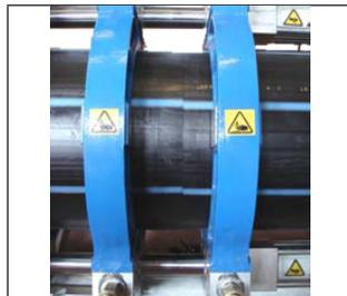
5. Contrôler l'alignement, en vérifiant le parallélisme entre les extrémités des tubes à souder (tolérance de 0,5 mm maximum) et en vérifiant le désalignement (tolérance maximale de 10 % de l'épaisseur du tube).
