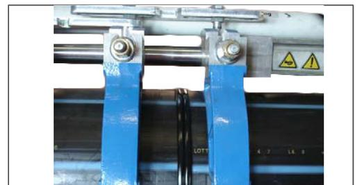
9. Augmenter progressivement la pression (rampe de pression) de zéro à la pression requise  $p_1$  en temps  $t_4$  et la maintenir pendant un temps  $t_5$ .
