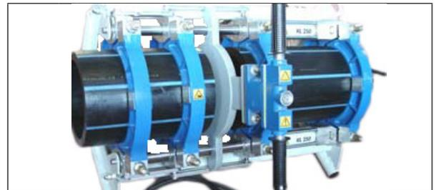
6. Nettoyer les faces de la plaque de soudure avec de l'isopropanol (alcool). Vérifier à l'aide d'un thermomètre de contact que la température de la plaque se situe entre 210 et 225 °C. Vérifier la pression d'entraînement et l'inscrire sur la feuille de soudage. Calculer  $p_r$ , la pression pour la formation du bord initial (pression de soudage tabulée + pression de traînée) et l'inscrire sur la feuille.
