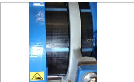
7. Placer la plaque entre les tuyaux à souder et presser les extrémités de contre la plaque à la pression calculée  $p_r$ , jusqu'à ce qu'un bord initial uniforme de hauteur  $h$  soit formé.
