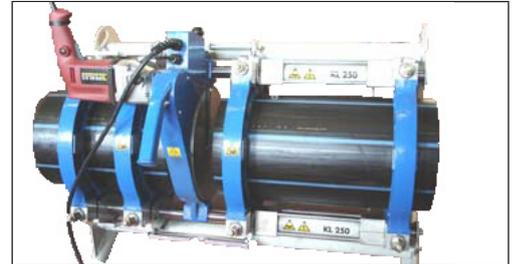
3. Poncer les tubes jusqu'à ce que leur surface transversale soit complètement propre.
