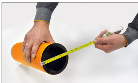
1. Mesurer le diamètre du tube. Measure diameter of the pipe.
