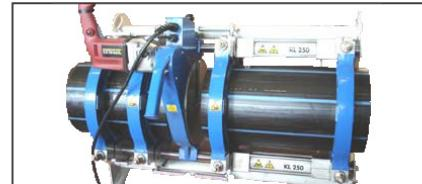
1. Emplazar el equipo de soldar a tope. Caso necesario, por lluvia, frío o viento, montar una tienda o similar.
