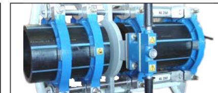
4. Eliminar virutas sin tocar con las manos la superficie refrentada. Remove chips without touching the facing surfaces.
