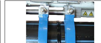
7. Poner la placa entre los tubos a soldar y presionar sus extremos a la placa, a la presión calculada  $p_1$ , hasta formar un bordón inicial uniforme y de altura h. Reducir la presión a  $p_2=10\% p_1$ , para el calentamiento.
