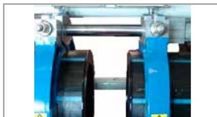
8. Pasado el tiempo de calentamiento  $t_2$  (tabulado en cada máquina), separar los tubos de la placa. Retirar la placa y unir rápidamente los extremos de los tubos en un tiempo máximo  $t_3$ .
