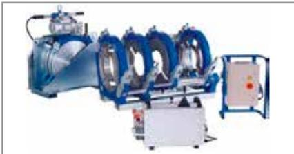
1. Emplazar el equipo de soldar a tope. Caso necesario, por lluvia, frío o viento, montar una tienda o similar.
