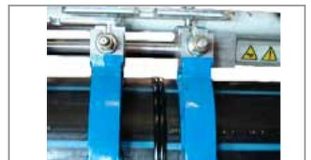
9. Aumentar progresivamente la presión (rampa de presión) desde cero a la presión requerida  $p_1$ , en un tiempo  $t_4$  y mantenerla durante un tiempo  $t_5$ . Dejar enfriar la soldadura en esta posición sin quitar la presión  $p_1$  ni aflojar las abrazaderas. Pasado el tiempo de enfriamiento aflojar las abrazaderas y retirar el tubo de la máquina.
