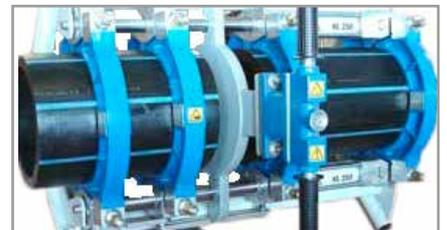
6. Limpiar las caras de la placa de soldar con isopropanol (alcohol). Comprobar con un termómetro de contacto que la temperatura de la placa esté entre 210-225 °C. Comprobar la presión de arrastre y anotar en la ficha de soldadura. Calcular  $p_1$ , la presión para la formación del bordón inicial (presión de soldadura tabulada + presión de arrastre) y anotar en la ficha.
