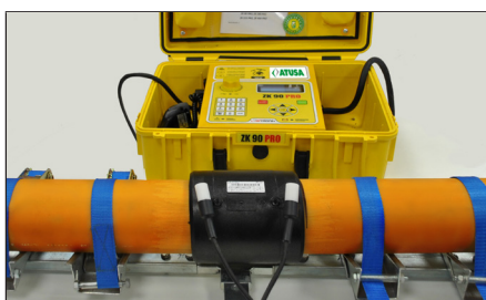
11. Inicio de la soldadura. Start welding.
