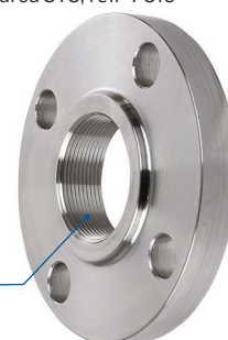
Rosca de unión hembra - Rp conforme EN 10226-1 (cilíndrica y con estanqueidad en la rosca)
