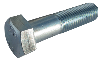
Tornillo de cabeza hexagonal de acero al carbono zincado con rosca parcial EN ISO 4014 (DIN 931) - Clase 8.8 - Carbon steel hexagonal head bolt with partial thread and zinc coated EN ISO 4014 (DIN 931) - Class 8.8
