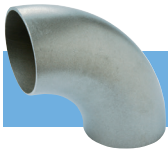
EDELSTAHL SCHWEISSBOGEN 90° 3D TYP A EN10253-4 AUS GESCHWEISSTEM ROHR
